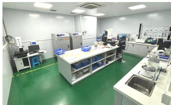
**不断完善的实验室：满足来料检测，制成检测，出货检测的全部条件。配备ROHS、二次元、CCD，抗撕拉拔检测，视频显微镜、VOC、以及光学检测应用需求的各种精密仪器**
